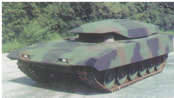
Rys. 10. Pojazd wykonany na bazie czołgu Leopard 2 w technologii obniżonej wykrywalności EGS (fot. Krauss-Maffei). [3]
