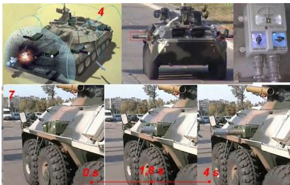
Rys. 2. Schemat działania systemu Zaslav wraz z widokiem przygotowania modułów ochronnych do pracy bojowej (fot. Immersion Hi Tech LTD) [3]
