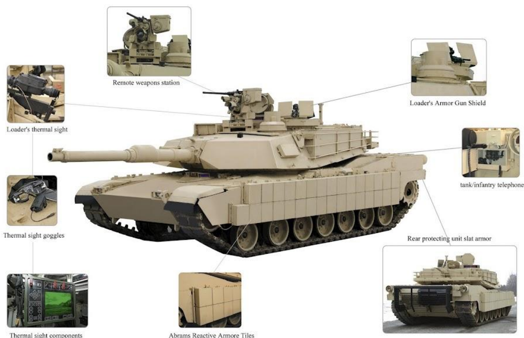
Rys.7. Zestaw pakietu modernizacyjnego TUSK-1 do czołgu M1A2 Abrams (fot. US Army) [3]
