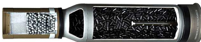
Rys. 10. 120 mm amerykański pocisk „kartaczowy” M1028 (fot. General Dynamics) [2]
