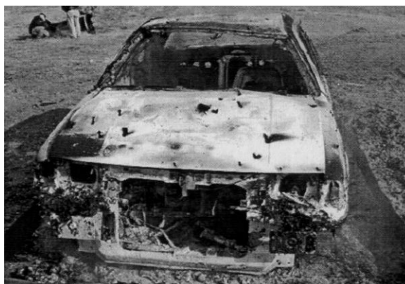
Rys. 11. Samochód po ostrzeleniu pociskiem kartaczowym (widok z przodu) [2]
