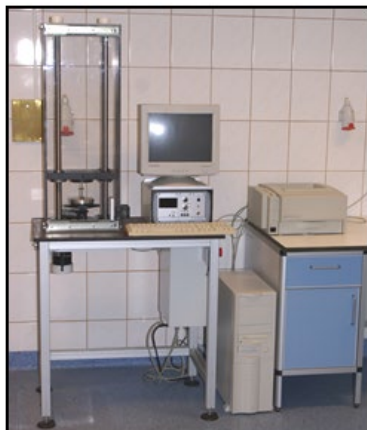
Stanowisko do badania sprężyn
