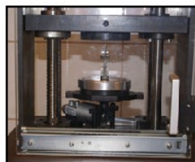
Stanowisko do badania sprężyn
