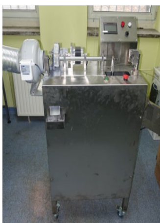
Stanowisko do badania opóźniaczy pirotechnicznych
