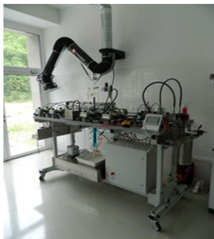
Automatyczny detektor gazów powstających w wyniku spalania prochów
